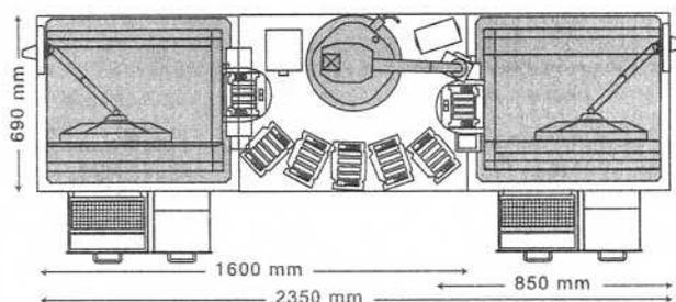
**Figura 2: Esempio di configurazione con due scanner e un AutoLoader 2.x:** due sistemi iScan con un AutoLoader 2.x possono facilmente essere posizionati su normali banchi da laboratorio. L'altezza del sistema, monitor escluso, è di 510 mm. Sono disponibili ulteriori configurazioni del sistema iScan con gli AutoLoader.
