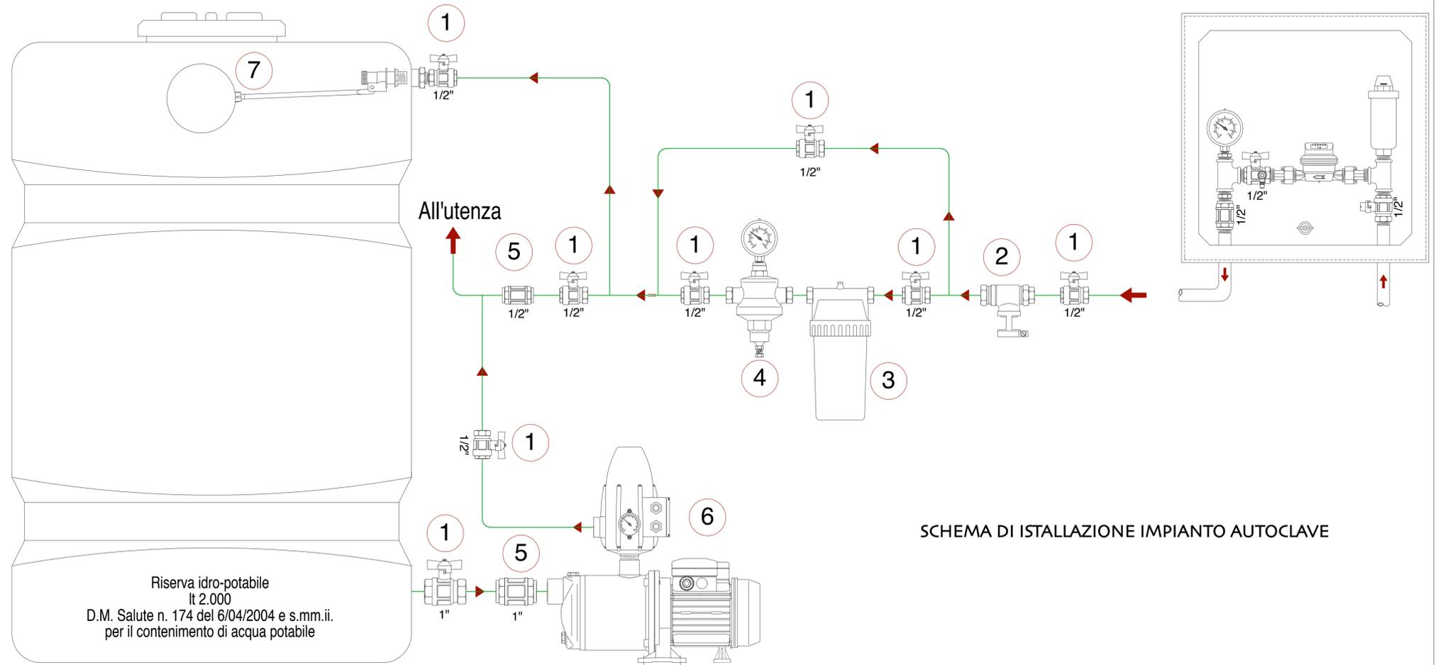
**SCHEMA UNIFILARE IMPIANTO AUTOCLAVE**
